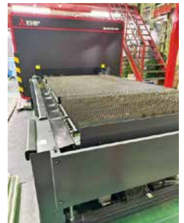
金属切断用レーザー加工機。今年5月に導入
